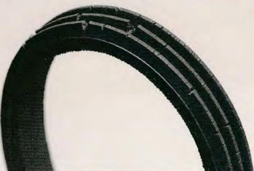
補機ベルトは、エンジンの回転を利用してオルタネータ(発電機)、ウォーターポンプ(冷却水循環装置)、エアコンのコンプレッサ、パワーステアリングポンプ等を動かすために動力を伝達しているベルトです。ゴム製品であることから使用しているうちに劣化、ひび割れ、伸び等が発生し、滑りや切断により、各補機の機能が失われる可能性がありますので適切な時期に交換することが必要です。
